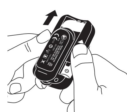
4. Le cas échéant, retirez les piles du modèle 3230. Mettez les piles au rebut de manière conforme aux réglementations.
