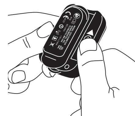
3. Faites glisser le volet du compartiment des piles dans la direction opposée et retirez-le du modèle 3230.
